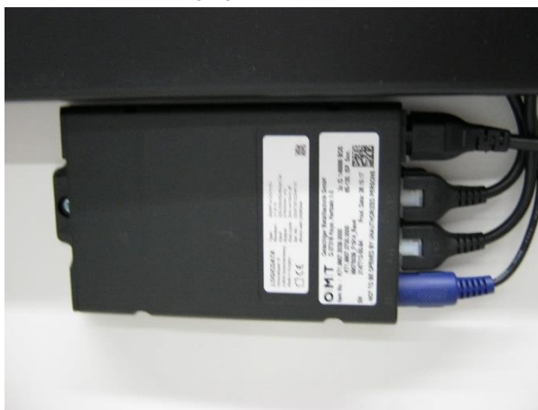
Figuur 8: Beproefd exemplaar 170610-2 van Voortman Hi Tee zit/statafel op T-poten - detail onderaanzicht regelunit voor de verstelling.
