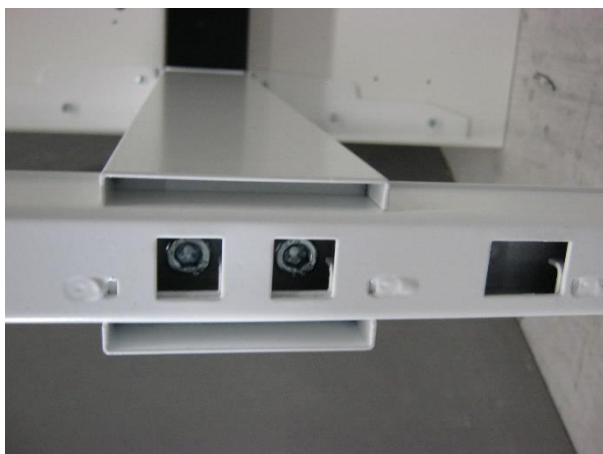
Figuur 9: Beproefd exemplaar 170610-2 van Voortman Hi Tee zit/statafel op T-poten - onderaanzicht detail montage poot.
