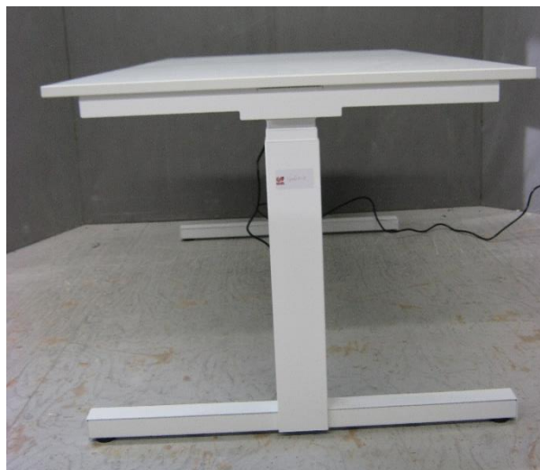
Figuur 2: Beproefd exemplaar 170610-2 van Voortman Hi Tee zit/statafel op T-poten - zijaanzicht laagste stand.
